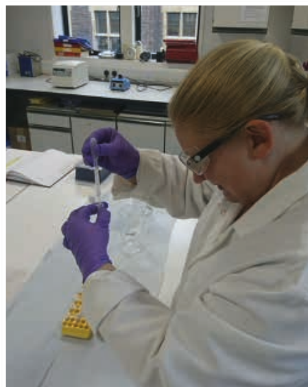
Bilde 3 viser en del av renseprosessen som skal sikre at tannemaljen som skal inn i massespektrometret er renet mest mulig. Denne prosessen blir gjerne utført i flere prosesser, der kjemisk rensing og spinning er en del av stegene.
